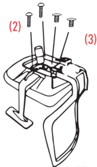
Asegure el espaldar colocandolo en los orificios del asiento, de manera que la perilla quede hacia el frente.
