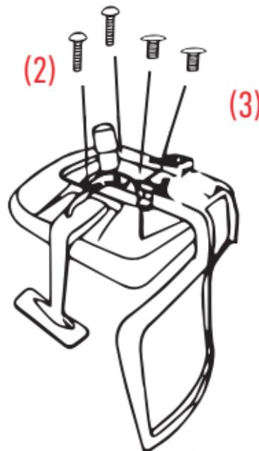
Asegure el mecanismo colocandolo en los orificios del asiento de manera que la perilla quede hacia el frente.
