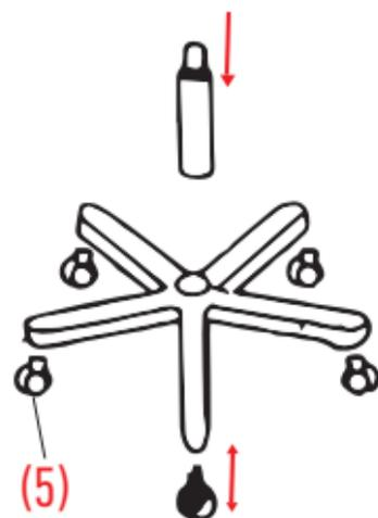
Asegure las 5 ruedas a la base, coloque el neumático como lo indica la flecha.
